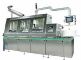
Автоматическая линия розлива EL1 для пакетов объемом 500 мл и 1000 мл
